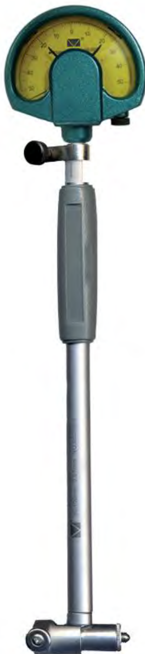
Рисунок 1 - Нутромер индикаторный НИ с механическим отсчетным устройством рычажно-зубчатого типа ИИГ.
